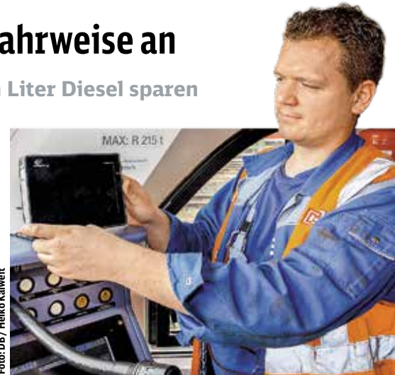
Einbau eines RESY-Geräts in einen Dieseltriebwagen
